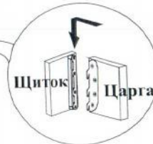
Схема установки навеса для царги
