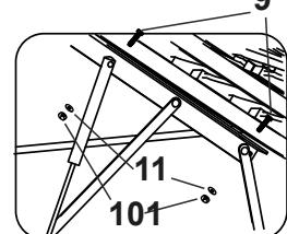
ВНИМАНИЕ! Газлифт крепится на подъемный механизм цилиндром вверх как на схеме.
