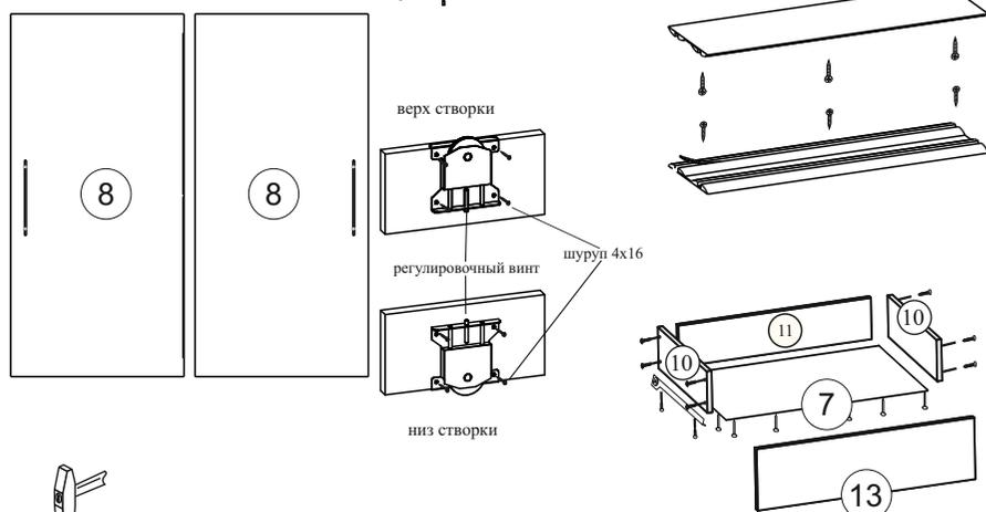
Верхняя Ш-образная направляющая: снять защитную пленку скотча и прикрепить направляющую к крышке вплотную к краю.
