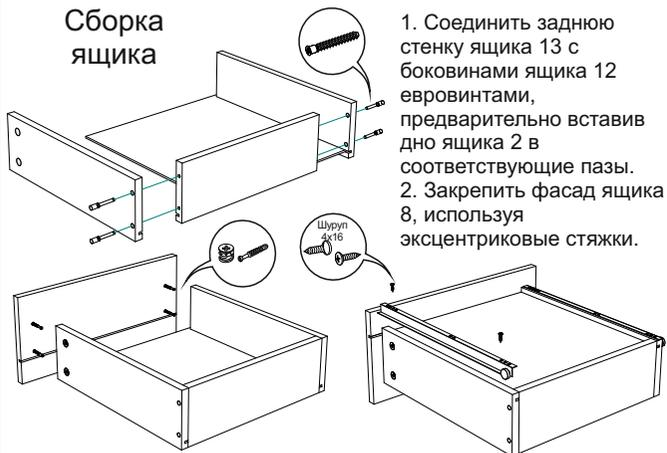
1. Соединить заднюю стенку ящика 13 с боковинами ящика 12 евроинтами, предварительно вставив дно ящика 2 в соответствующие пазы.
