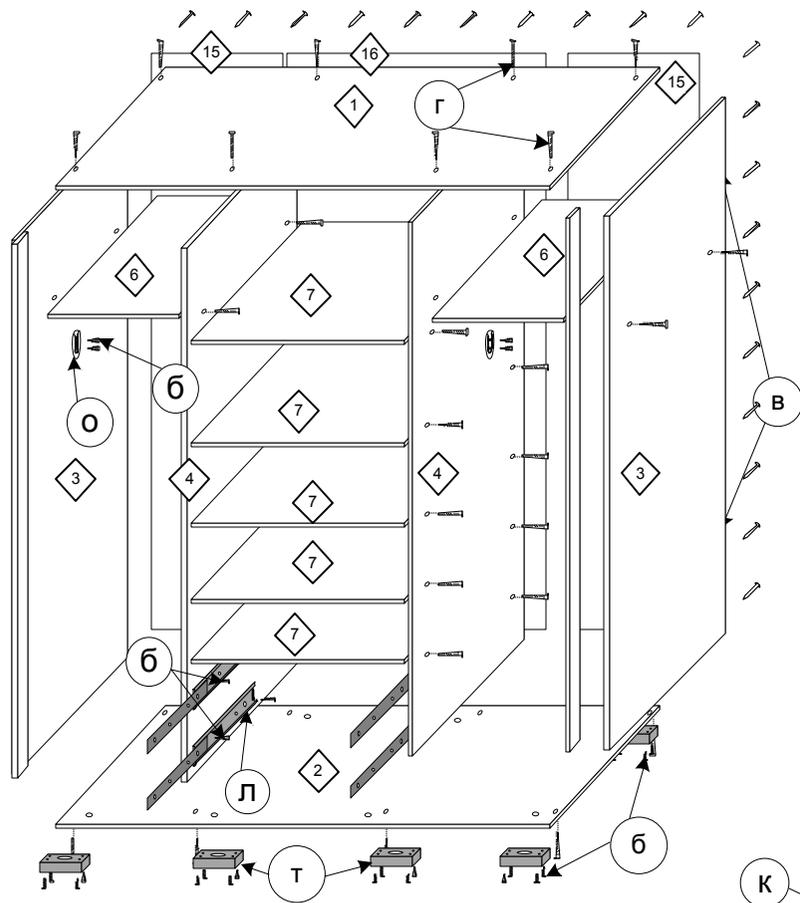
Схема сборки каркаса шкафа
