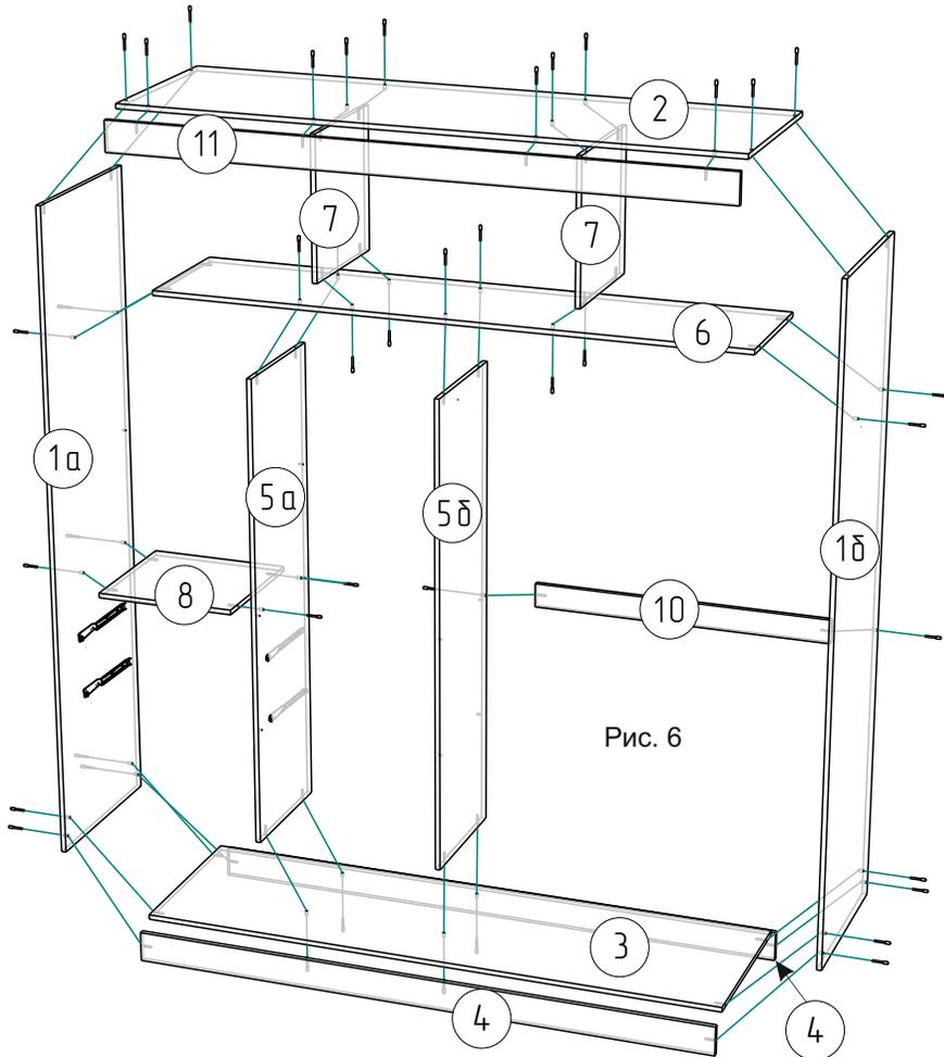
Замерьте диагональ собранного каркаса и прибейте заднюю стенку ЛДВП гвоздями 2х20 с расстоянием между ними 10 см. (См. рис. 3)
