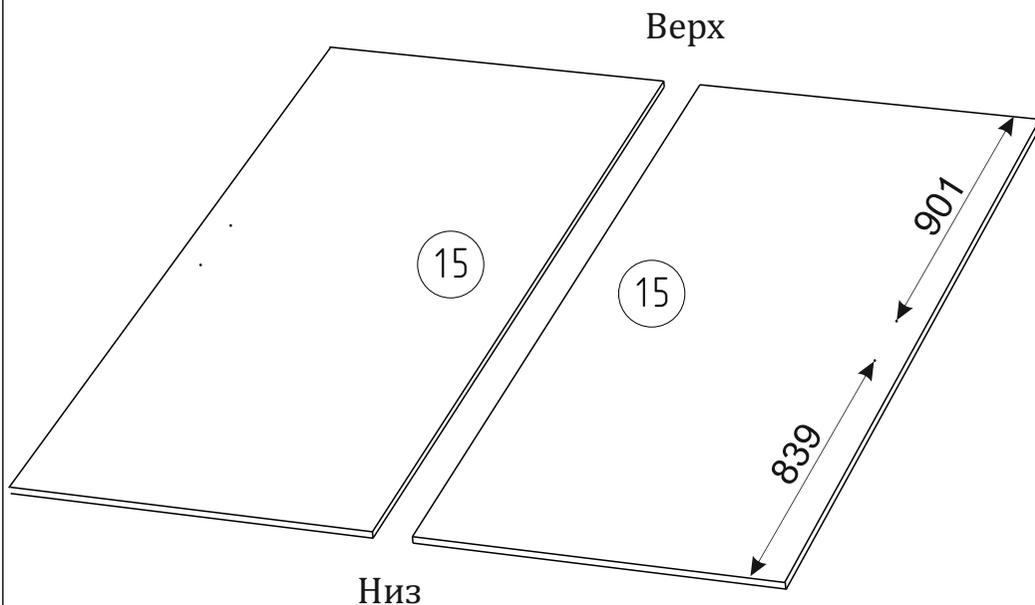
Нижние ролики приверните шурупами 4x16 к (дет. № 15) по две на каждую деталь.
