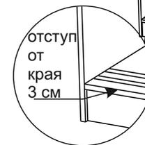
**ВНИМАНИЕ!** Прежде чем прикрутить нижнюю направляющую, в рельсы нужно вставить стопор в каждую рельсу по одному с двух сторон.
