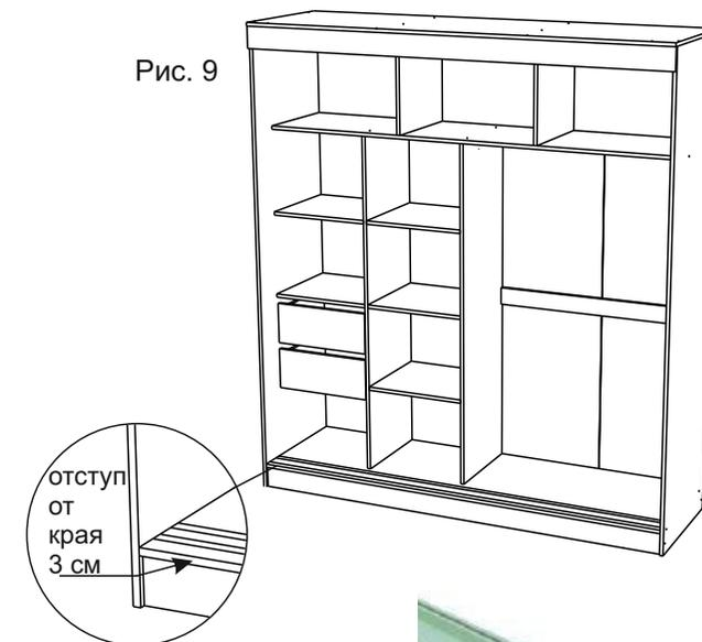
**ВНИМАНИЕ!** Прежде чем прикрутить нижнюю направляющую, в рельсы нужно вставить стопор в каждую рельсу по одному с двух сторон.
