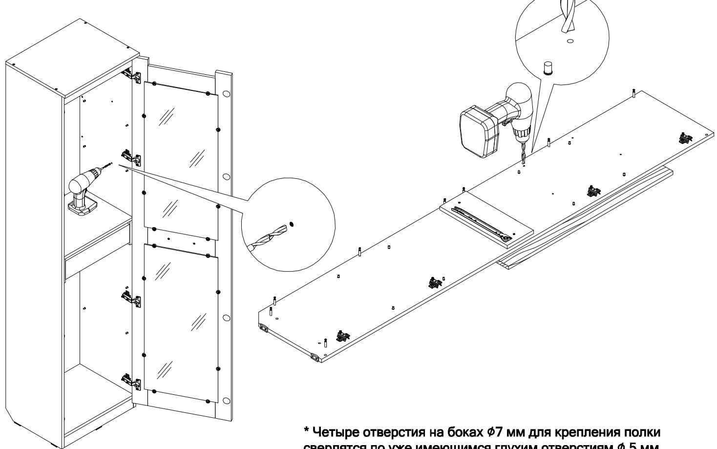
\* Четыре отверстия на боках Ø7 мм для крепления полки сверлятся по уже имеющимся глухим отверстиям Ø 5 мм
